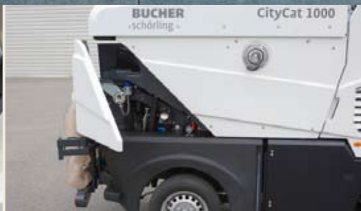
Kryty servisních otvorů s magnetickými příchýtkami
